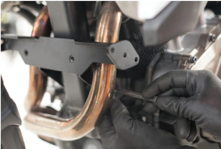
6. Retirez les trois boulons de droite – celle du conducteur. Servez-vous d'une douille de 12 mm emmanchée et d'une clé à cliquet.
