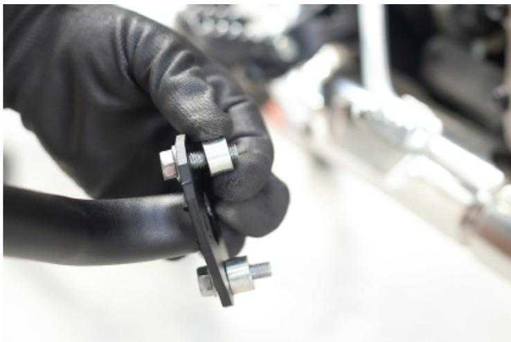
8. Commencez à monter soigneusement la languette arrière tout en veillant à ne perdre les écarteurs.
