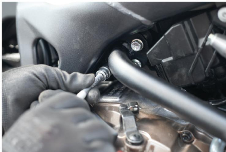
12. En vous servant d'une clé plate de 12 mm, vissez doucement l'écrou, en veillant à ne pas encore le serrer complètement.
