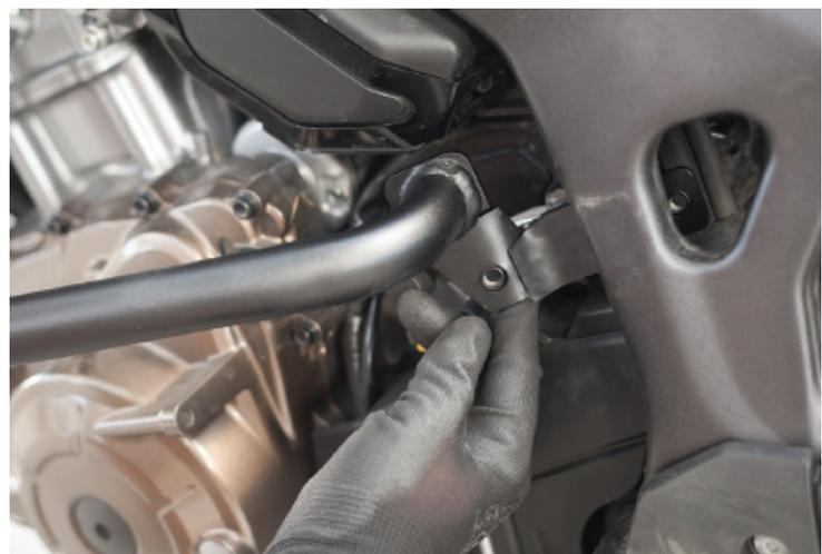
14. Nous vous conseillons de passer l'un des boulons à tête hexagonale de 6 mm à travers la languette de montage avant, afin d'immobiliser partiellement la barre de protection. N'oubliez pas d'ajouter la rondelle et l'écrou de blocage.
