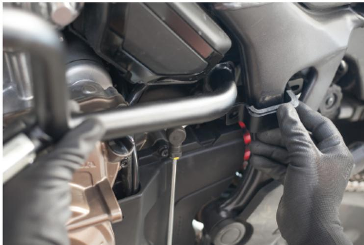
16. Une fois que la patte de fixation sera bien en place, vissez à la main les boulons à tête hexagonale à filetage 8 x 110 mm (numérotés 9 sur la liste de la « quincaillerie »). N'oubliez pas de mettre les rondelles et de verser de la colle bleue de freinage des filetages.
