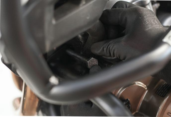
4. Montez le vis-à-vis de la patte de fixation sur la barre de renforcement. Insérez les deux boulons à tête ronde à six pans creux fournis. Positionnez les rondelles et vissez à la main les écrous-freins.
