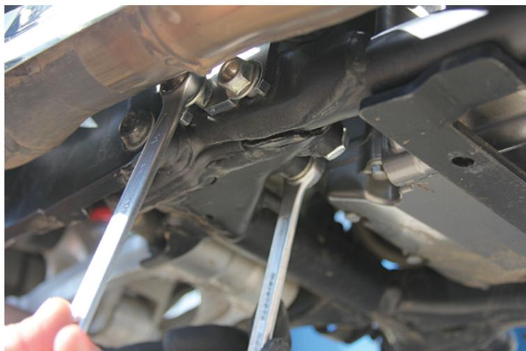
10. Procédez au montage du côté droit de la barre de protection moteur. Conseil : la tâche vous sera facilitée si les boulons traversants ne sont pas enfoncés jusqu'au bout. Laissez-les dépasser de 10 mm/0,5 pouce, puis assurez-vous que la patte de fixation se trouve parfaitement sur la bride supérieure de la barre de protection contre les chocs.
