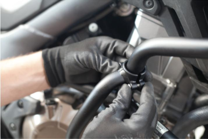
12. Prenez les deux boulons à six pans creux (M8) (pièces numérotées 5). Nous vous conseillons de vous servir d'une douille à six pans creux, ainsi que d'un manche clé à cliquet, et de ne serrer les deux boulons qu'une fois que les deux trous de montage seront alignés. Conseil : assurez-vous que la bride de montage installée sur le cadre n'est pas trop serrée, de façon à pouvoir aligner les trous correspondants.
