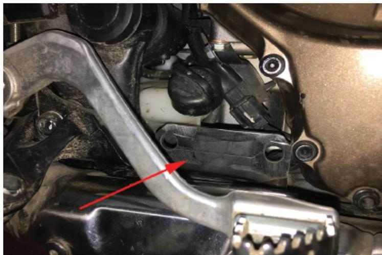
8. Une fois que la bride de montage arrière sera bien en place, commencez à visser l'écrou plat (pièce numérotée 7) sur le boulon traversant à l'avant.
