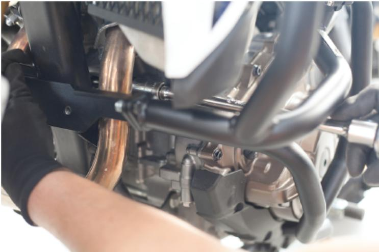
14. Refaites la même opération pour ce qui est cette fois du boulon traversant du bas, en vous servant d'une douille et d'une clé plate de 13 mm.
