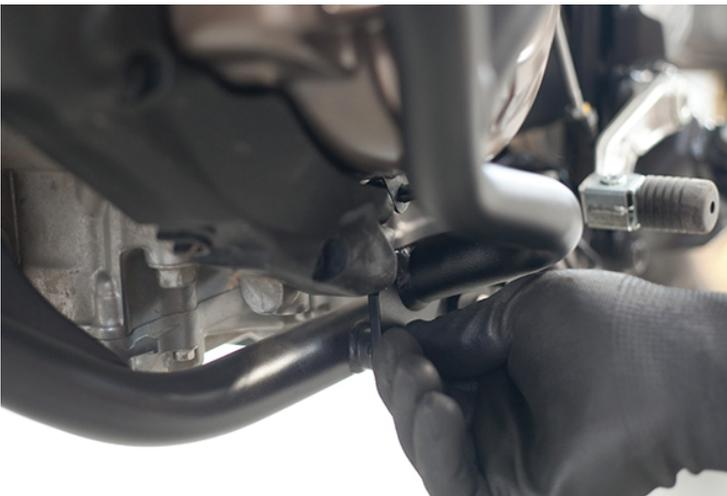
6. Passez au côté droit (côté échappement) de votre bécane Africa Twin. Regardez sous la moto : vous verrez deux boulons traversant fixés au cadre. En vous servant de deux clés plates de 14 mm, desserrez et enlevez uniquement les deux boulons se trouvant de l'autre côté du cadre. Vous n'aurez PAS BESOIN de retirer les boulons traversants.
