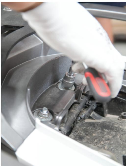
4. Montez les deux la ferrure de fixation fournies à l'aide des boulons d'origine (usine).
