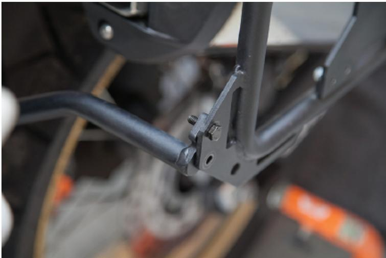
13. Après avoir aligné les trous de montage, procédez à l'insertion des boulons à tête hexagonale de 6 x 20 mm et vissez-les à l'aide des rondelles et des écrous de blocage/verrouillage fournis.
