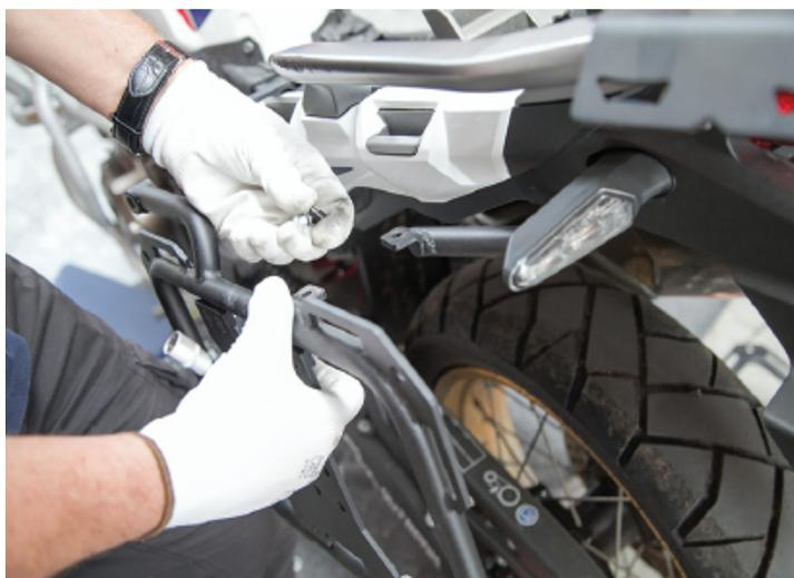
8. À l'aide d'un boulon à six pans creux de 8 x 40 mm, de sa rondelle et de son écrou de blocage/verrouillage, fixez le haut du côté gauche du porte-bagage dans la ferrure de fixation prémontée. Ne pas procéder au serrage à ce stade.
