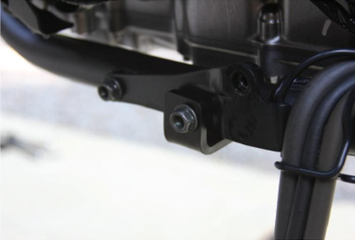
4. Montez le sabot sous moteur. Insérez d'abord les deux boulons à tête ronde à six pans creux de 8 x 20 mm (M8) avec leur rondelle, vissez à la main et serrez doucement en vous servant d'une clé mâle à six pans creux de 5 mm ou d'une douille à six pans creux de 5 mm. Ne pas serrer à fond.
