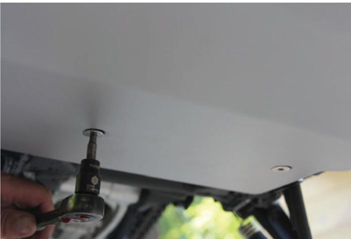
6. Serrez le boulon de la bride de montage du sabot au moyen d'une douille de 12 mm et d'une clé à cliquet. Le couple de serrage recommandé en usine est de 44 Nm.
