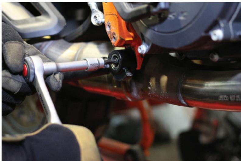
**10. Serrez complètement tous les boulons, et vérifiez que les crochets soient correctement tendus (bien positionnés dans l'encoche).**
