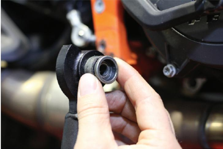
4. Montez la béquille centrale et vissez les boulons à tête hexagonale/torx de type M8 des deux côtés. Servez-vous de colle de freinage des filetages.
