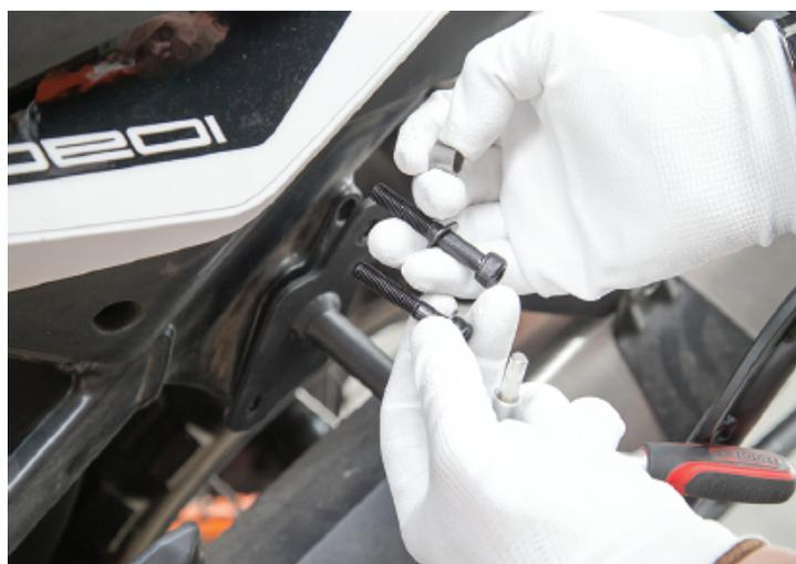
6. Insérez les deux boulons et vissez-les à la main. Ne pas trop serrer !
