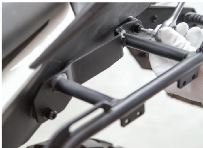
8. À l'aide d'un boulon à six pans creux de type M8 de 40 mm, de sa rondelle et de son écrou de blocage/verrouillage, reliez le haut gauche du porte-bagage à la ferrure de fixation prémontée.
