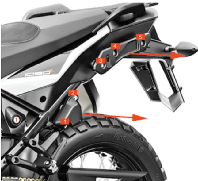
2. Installez le porte-bagage du côté gauche et fixez-le en haut à l'aide de l'un des boulons de type M8 de 300 mm. Ne pas le serrer à ce stade.
