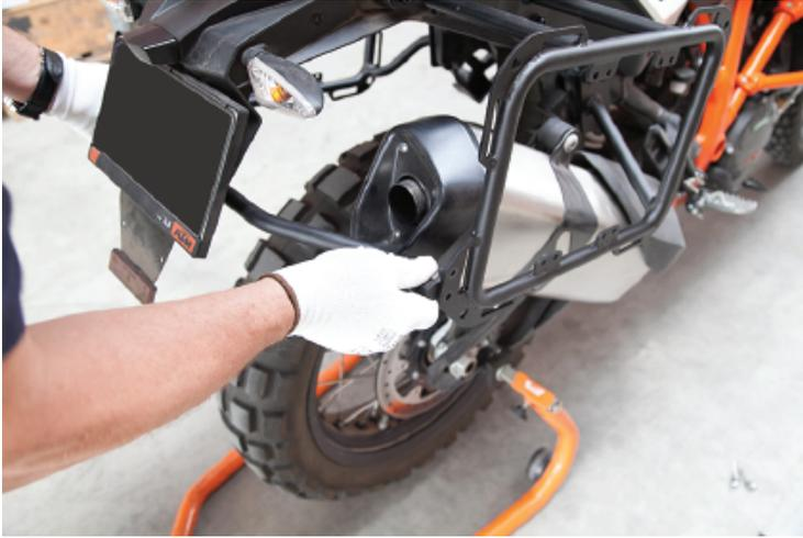
12. À l'aide de tous les 4 boulons à tête hexagonale de type M6 de 20 mm, de leur rondelle et de leur écrou de blocage/verrouillage, fixez le montant transversal arrière. Outils recommandés : une clé plate de 10 mm et une douille femelle de 10 mm avec une clé à cliquet, mais vous pourrez opter également pour l'utilisation de deux clés plates de 10 mm. **Pour terminer, serrez bien tous les boulons et écrous !**
