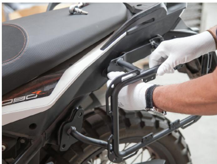
4. Assurez-vous que le porte-bagage ne soit pas complètement collé au reste, afin de pouvoir placer les écarteurs derrière la patte de montage.
