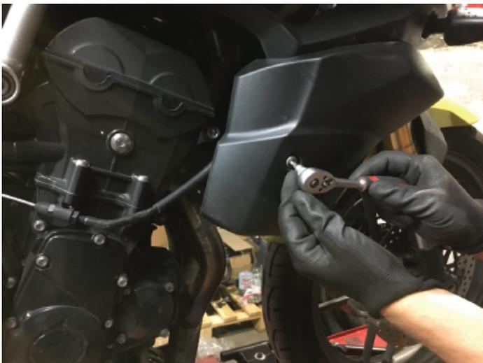
2. L'opération suivante consistera à démonter le le boulon intérieur, de chaque côté, droit et gauche de la moto.
