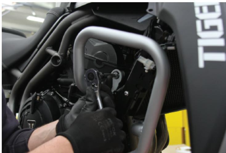
14. Insérez les deux boulons à six pans creux de 8 mm dans la patte de montage du bas sur la barre de protection et assurez-vous que vous ayez bien relié l'ensemble avec l'arceau de protection moteur. Installez une rondelle avant chacun des boulons et vissez avec précaution les écrous de blocage, sans les serrer. Le serrage au couple recommandé, qui sera de **20 Nm**, ne devra se faire qu'à la fin.
