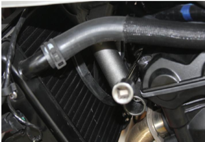
12. Installez l'arceau de protection moteur du côté droit. Appliquez du liquide de fixation pour filetage (bleu) et ne serrez pas complètement les boulons. Couple de serrage recommandé à la fin des opérations: 20 Nm.
