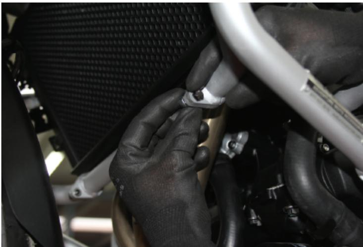
18. Serrez les 4 boulons, MAIS ce uniquement à la fin de l'opération. Le couple de serrage recommandé sera de **10 Nm**.
